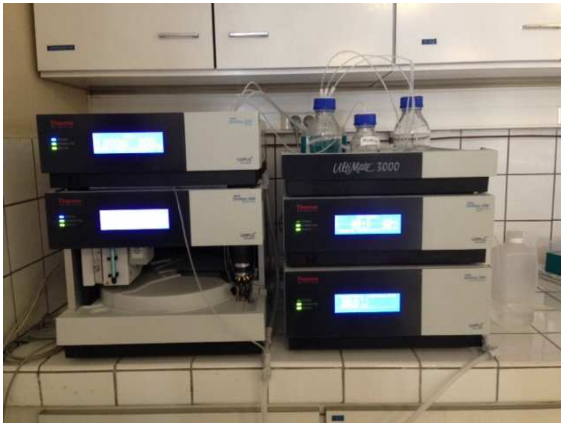
Figure 2 : système chromatographique Ultimate® 3000
